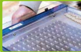
ストッパーを外し、右手側にある突起をゆっくり押ししてスライドさせ、大きな穴から種を植え穴に落とします。
