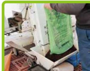
まず「土詰め機」に培養土をセット!この培養土1袋でトレー3〜4枚分土を詰められます。
